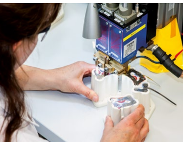
Das manuelle Punktschweißverfahren wird weiterhin im Muster- und Prototypenbau angewendet.
