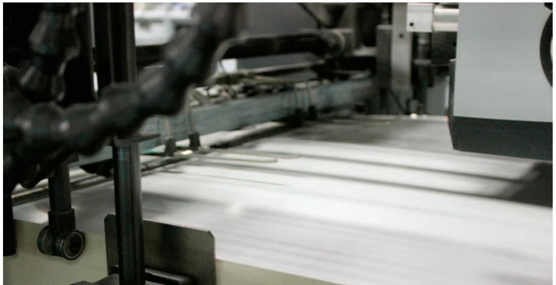
Einzug der unbedruckten Kartonbogen in die Maschine
