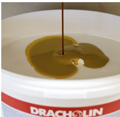
Automatische Pigmentdosierung an der Abfüllanlage
