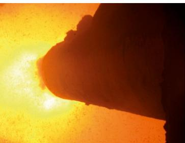
Brennerlanze mit Flamme im Drehrohrofen
