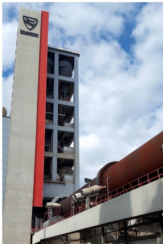
Drehrohrofen im Zementwerk
