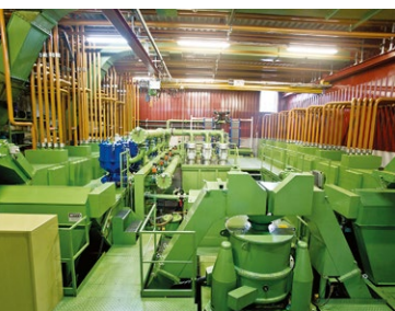
Blick in die zentrale Späne- und Kühlmittelaufbereitungs- anlage
