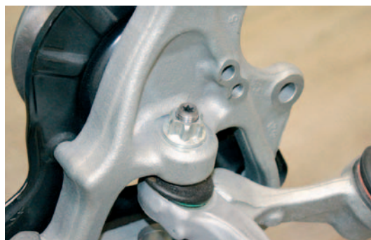
Verbaufall (exemplarisch) Leichtbaumutter Bild rechts: Produktionshalle Kaltfließpressteile am Standort Spaichingen
