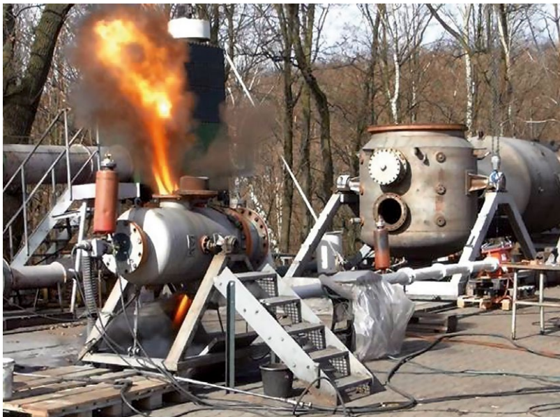
Explosionsschutz-Zertifizierung nach EN 16447
