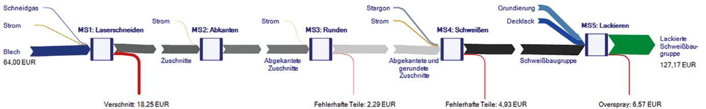
Sankey-Diagramme der mengenmäßigen sowie monetären Bewertung der Stoffströme gemäß MFCA am Beispiel der alten ProFlap Klappe
