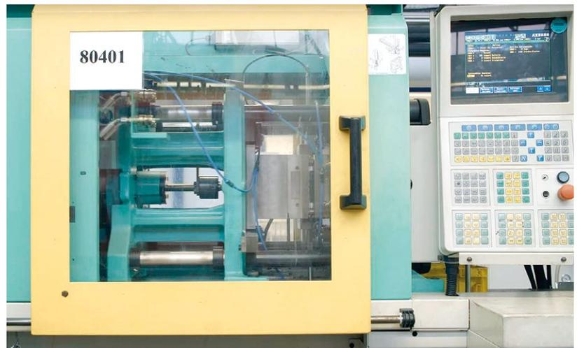
REProMag-Magnete können auf konventionellen Spritzgussmaschinen in Form gebracht werden
