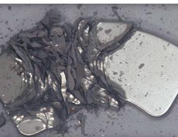
Unter Wasserstoffeinfluss pulverisierter NdFeB-Magnet einer Computerfestplatte
