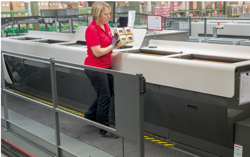
Kommissionierungsvorgang an einem Pick-it-Easy Arbeitsplatz
